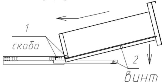
3. Вращением регулировочной шайбы, отрегулируйте высоту фасада ящика.
