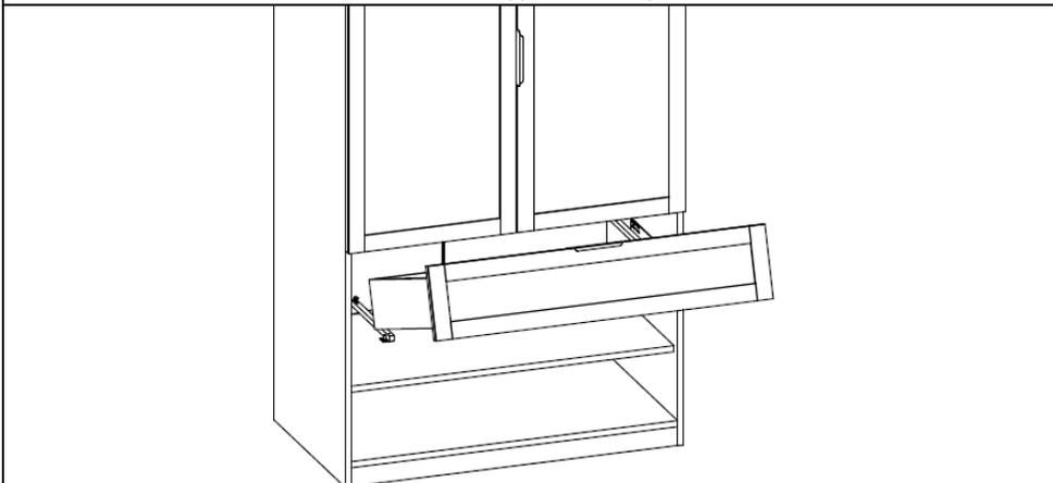
1. При установке ящика скобы выдвижных механизмов введите в отверстия на задней стенке ящика.
